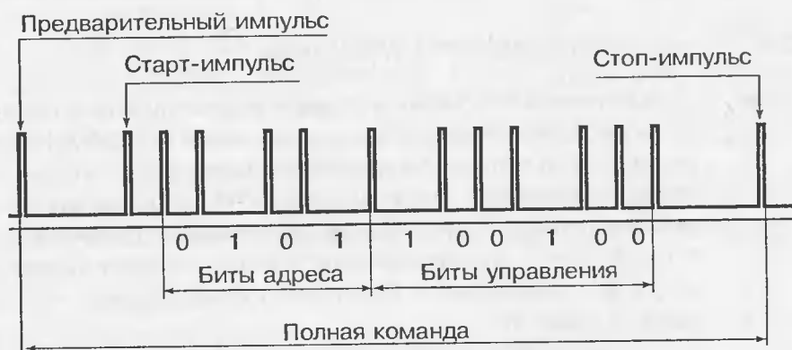
Рис. 2.13. Структура серии импульсов для командного слова
