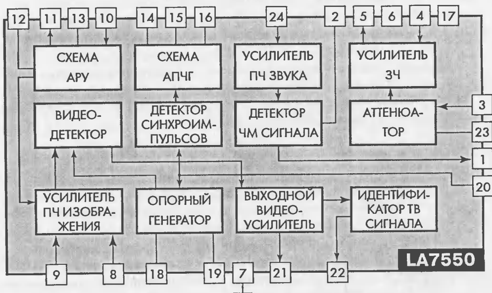
Рис. 2.3. Структурная схема и цоколевка микросхемы LA7550
